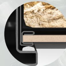
Края полотна завальцованы, что придает дополнительную жесткость и исключает вскрытие двери силовым отжимом.
