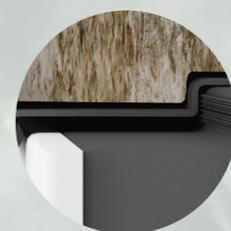
2 контура герметичного уплотнения по полотну и коробу («SCHLEGEL») надежно сохраняют тепло дома на долгие годы. Со временем не теряет герметичность, не деформируется и не накапливает влагу.
